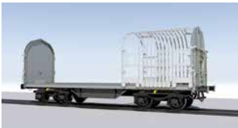
Railway SB・例：Shimmns ルーフを開いた状態
