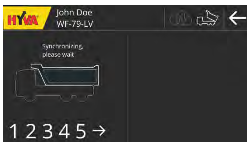
図45 積載重量の校正 — シンクロナイズ(同期)
